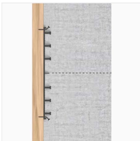
Stortvoegen wand-wand: bevestiging aan de bekisting.
